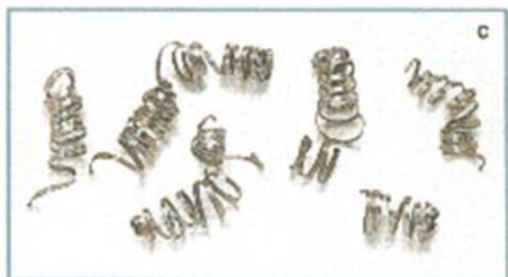
Свободно намотанная (витая) стружка - идеальные условия резания
