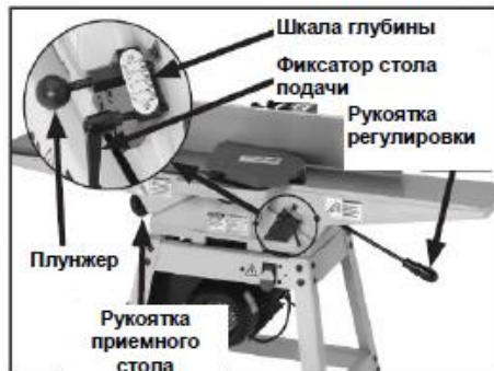
Рис. 18 Расположение элементов настройки стола
