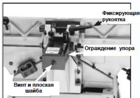
Рис. 12 Ограждение упора установлено
