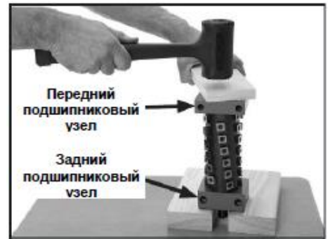
Рис. 59 Установка заднего подшипникового узла на ножевой вал helical
