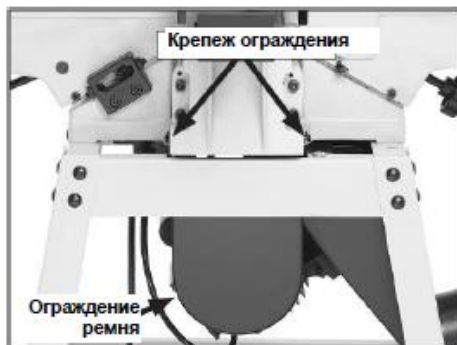
Рис. 9 Ограждение ремня установлено
