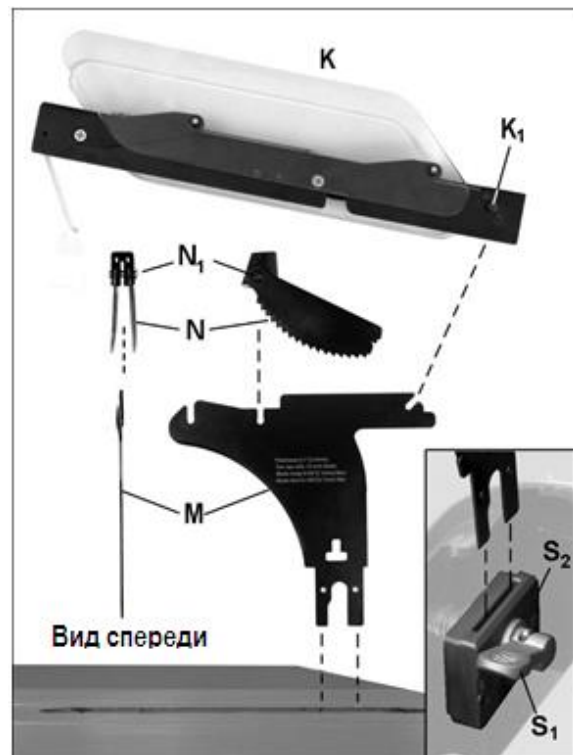
Рисунок 6-10: Установка защитного ограждения пильного диска.
