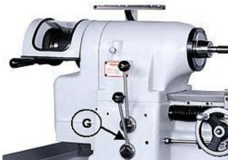
Рис.21 Контроль частоты и направления вращения шпинделя
