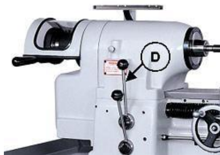
Рис.18 Контроль частоты и направления вращения шпинделя
