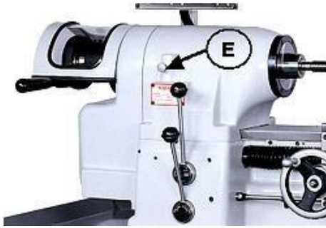
Рис.25 Контроль частоты и направления вращения шпинделя
