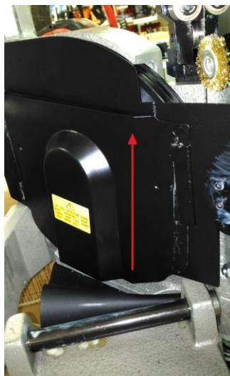
Выкрутите два болта (B, Рис. 9) и снимите защитный щиток полотна (A, Рис. 9) (окрашен красным цветом).
