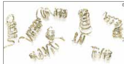
Свободно намотанная (витая) стружка – идеальные условия резания
