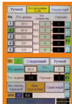
ЧПУ, сенсорная панель и установщик длины отрезаемой заготовки
