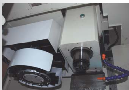
8-позиционный инструментальный магазин с механизмом смены инструмента
